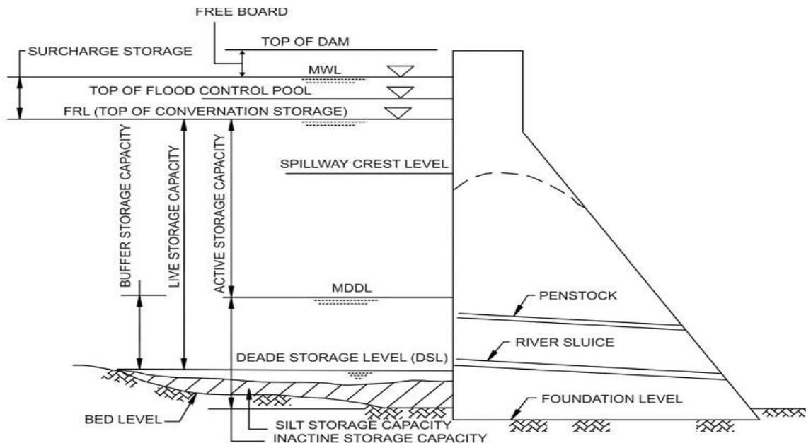
**SCHEMATIC DIAGRAM SHOWING ZONES OF STORAGE IN A RESERVOIR**
